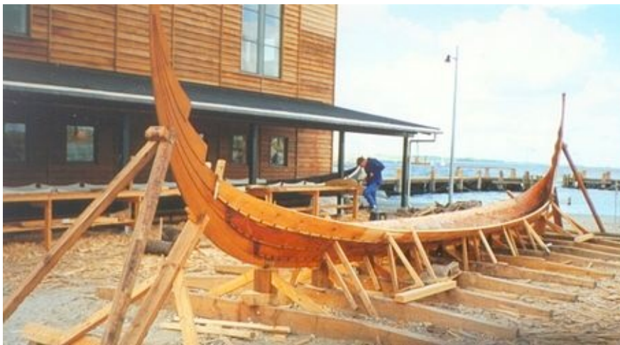
Bild 10. Bygge av en vikingabåt i Roskilde. Notera den höga och konstfullt huggna stäven närmast i bild. Bild: Wikipedia Commons
