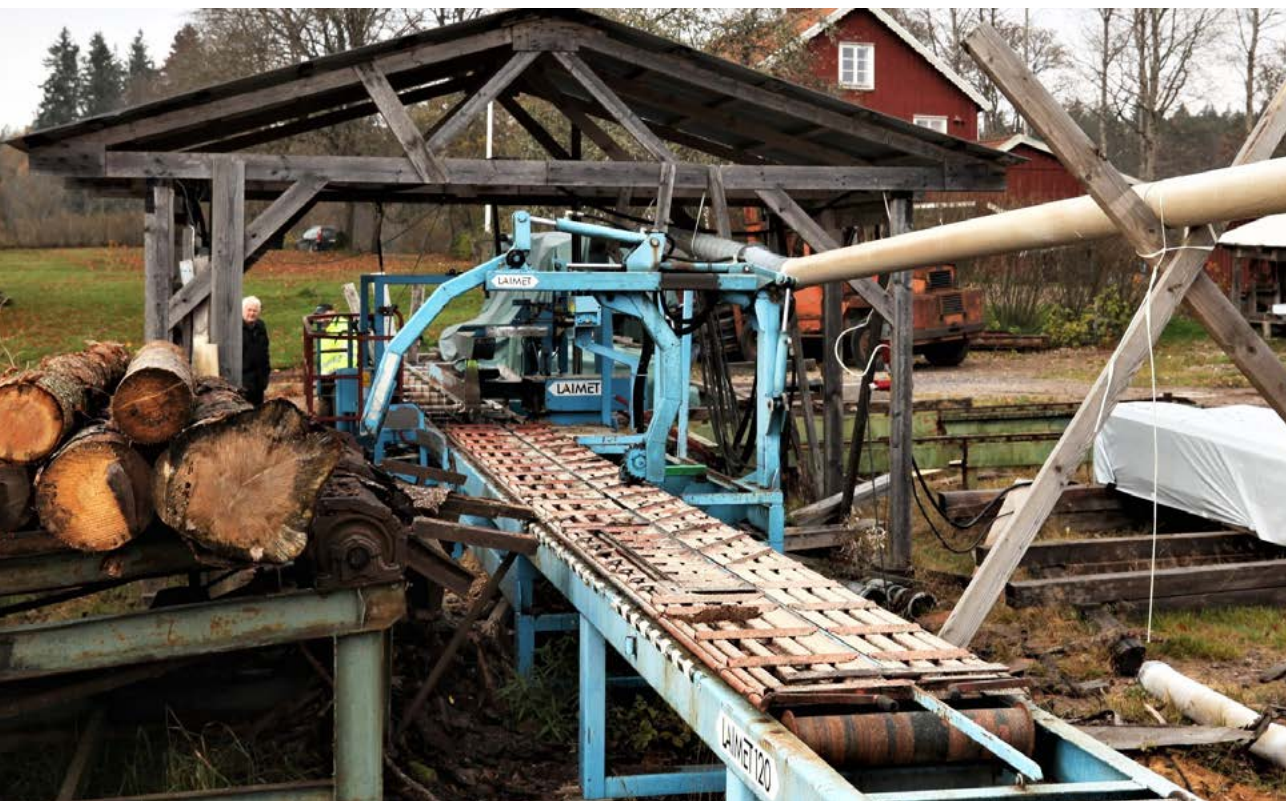
En modern enmansbetjäнад cirkelsåg för mindre produktion av sågat virke.
