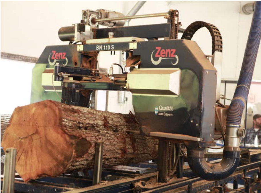
Liggande bandsåg för mindre produktion av grova stockar, särskilt lövträstockar.
