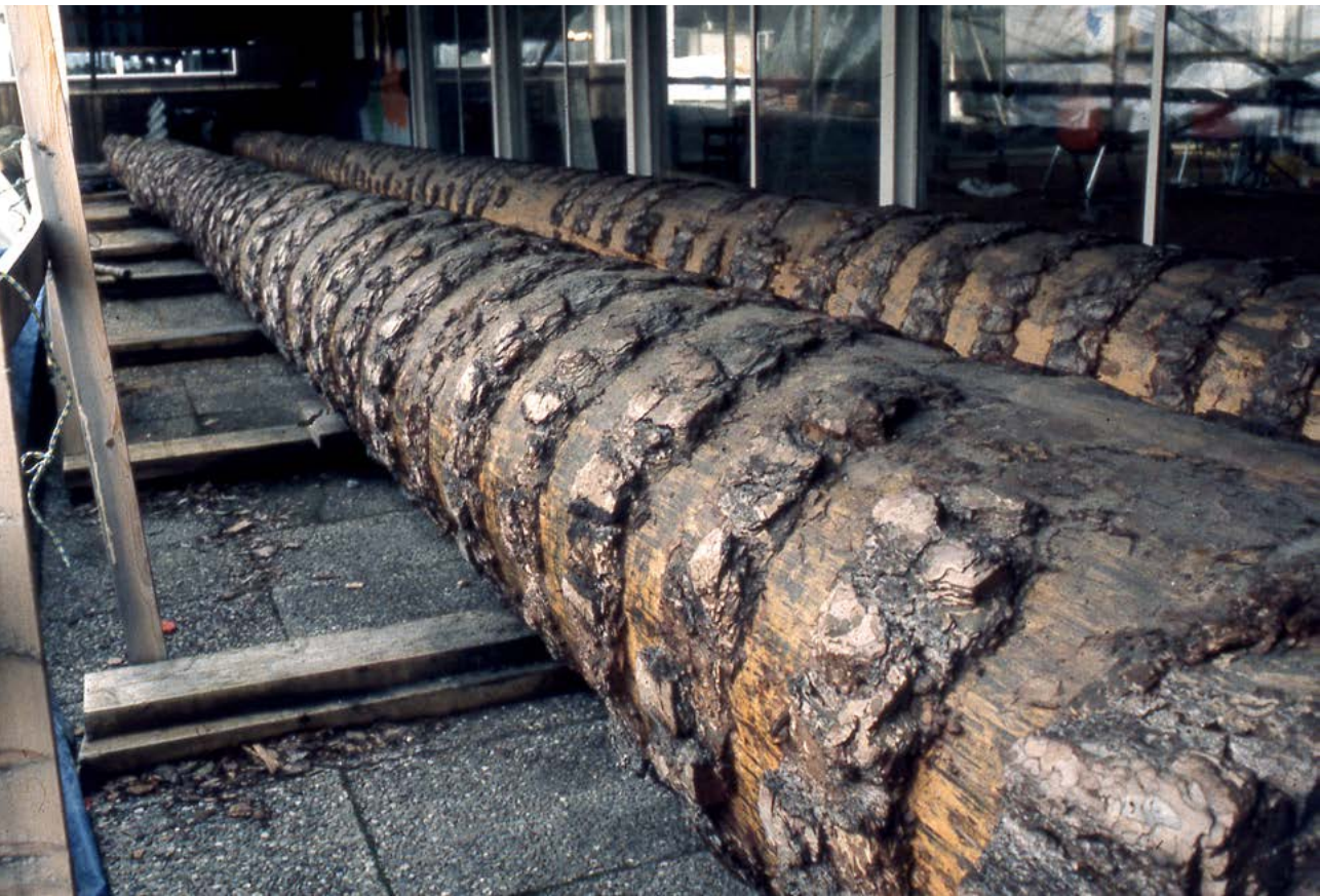
Ett ringbarkat ämne till en mast avsedd för skeppet Vasa.
