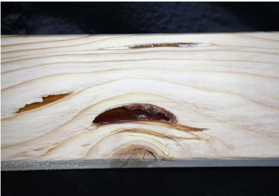
Kådlåpor i en fiberstörning vid en kvist i ett radialsnitt av gran. På grund av fiberstörningen har de två nedersta kådlåporerna ett utseende som liknar dem i ett tangentialsnitt på grund av fiberstörningen.
