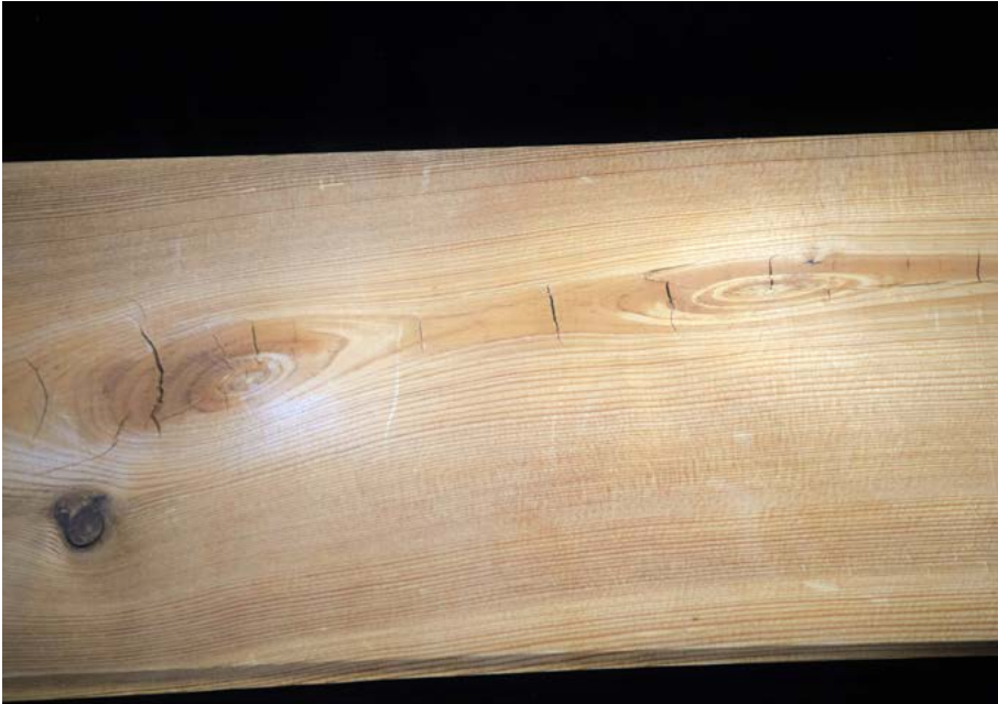
De tvärgående strecken i plankans mitt är vattved som torkat och spruckit.
