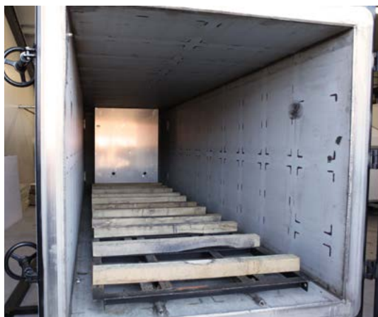
En »modern« kammartork för ett virkespaket.
