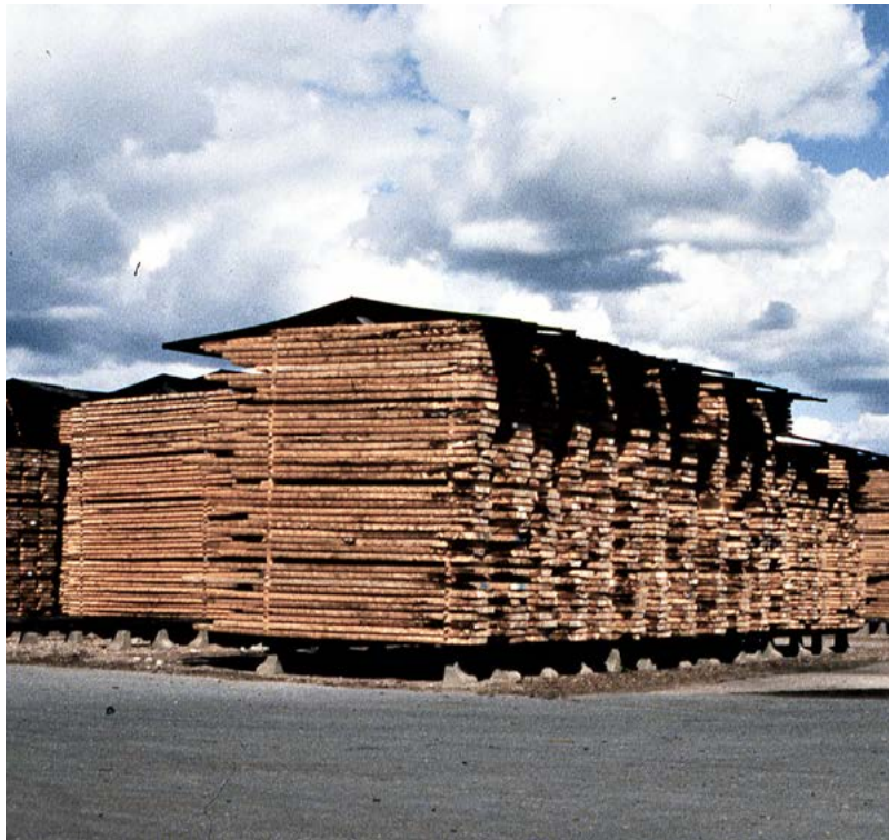
Brädgårdstorkning av sågat virke i taktäckta brädstaplar. Bild från ett medelstort sågverk i slutet av 1990-talet.
