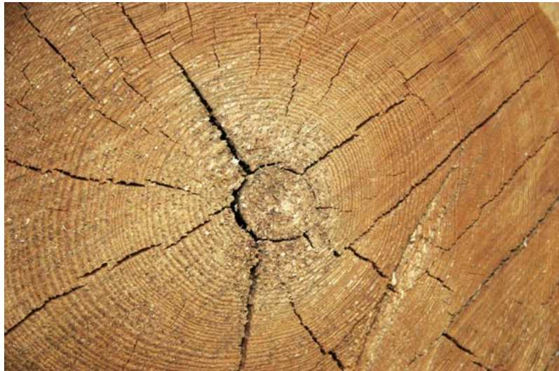
Tvärsnitt hos en gammal fullmogen furustock där de två bredare radiellt gående sprickorna är kärnsprickor, medan den cirkelformade sprickan är en ringspricka. De små radiella sprickorna är torksprickor som endast går en liten bit in i veden.
