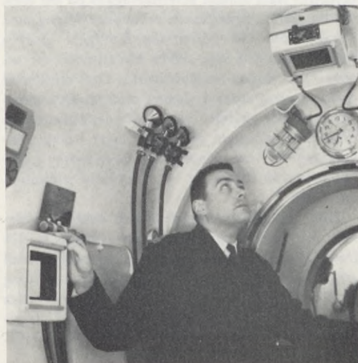
Figur 5. Interiör från rekompresionskammaren. Bilden visar bl a de kvadratiska visirbländarna, Bibs (built in breathing system) och dykartelefon.
