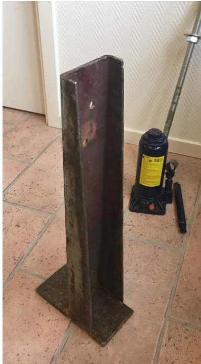
Figur 7. Nybergs lyftrigg av sammansvetsad u-balk och plattjärn. En 10 tons pelardomkraft och en M16 gängstång i bakgrunden (Hedman 2017)
