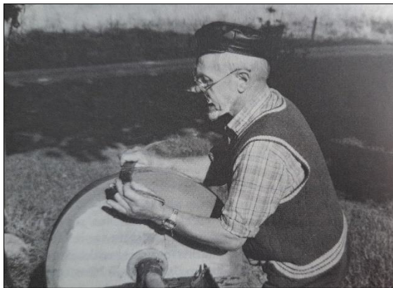
Figur 17. Bladet läggs på främre delen av slipstenen så att slipvattnet rinner ned över bladet. Bladet hålls stadigt (Persson & Nilsson 1988 s. 14).
