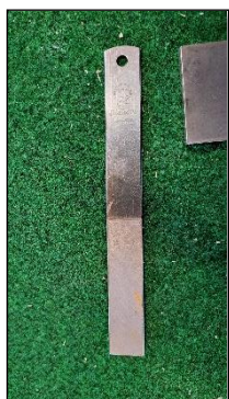
Figur 28. Ett diamanbryne med två olika kornstorlekar (Lundgren 2023).
