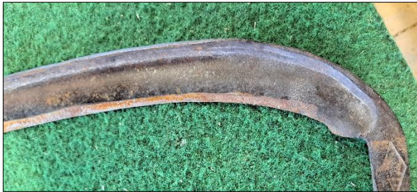
Figur 27. Bilden till vänster visar ungefärligt hur fasen brukar se ut när Michael har slipat. Han går inte efter faslängd utan slipar så att det inlagda stålet hamnar i mitten och efter lämplig eggvinkel. Fasen kan skilja sig åt beroende på hur tjock liebladet är (Lundgren 2023).
