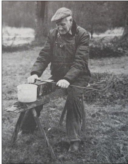
Figur 21. Skärpning av lien på en brynetavla. Vatten att fukta stenen med tas från burken. På bilden ses Erik Persson ifrån Skavbo (Persson & Nilsson 1988 s. 21).
