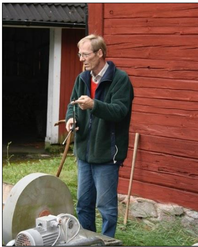
Figur 34. Kjell visar hur han gör för att kontrollera liebladet genom att lyssna till ljudet när han slår på det (Swedin 2000-tal).
