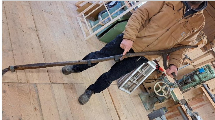
Figur 33. Bilden visar Michaels orv som han tillverkat efter en lokal modell. Michael pekar här på nedre handtaget som är vinklat nedåt för att handleden ska kunna hållas rak vid arbetet (Lundgren 2023).
