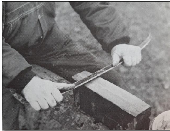
Figur 21. Skärpning av lien på en brynetavla. Vatten att fukta stenen med tas från burken. På bilden ses Erik Persson ifrån Skavbo (Persson & Nilsson 1988 s. 21).
