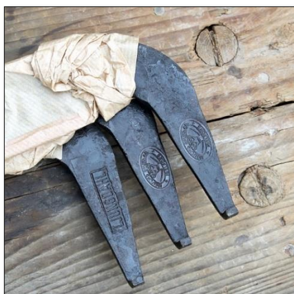
Figur 41. På bilden syns tre nya lieblad. Det går att se att de är märkta med Ljungdahl och Igelfors. Bladen är 4 kvarter långa (Broman 2015).
