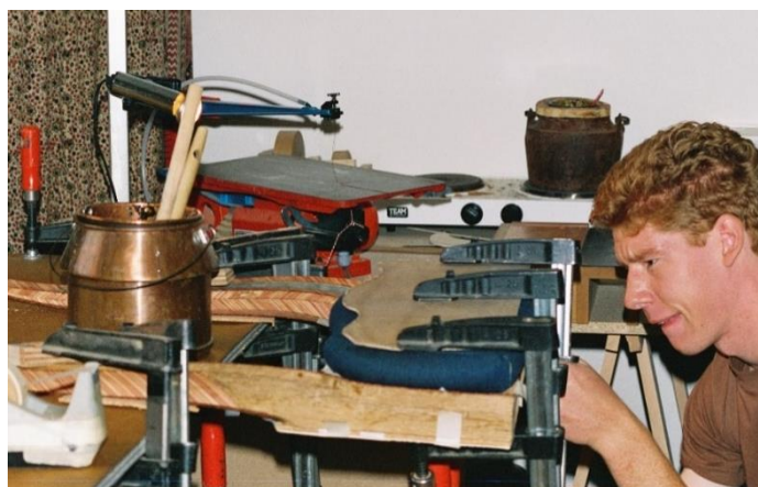
Figur 8: Declerck limmar en panel. Här syns en sandsäck (blå) anpassad för panelen, en plywoodskiva ovanpå den och sedan tvingas det ihop.
