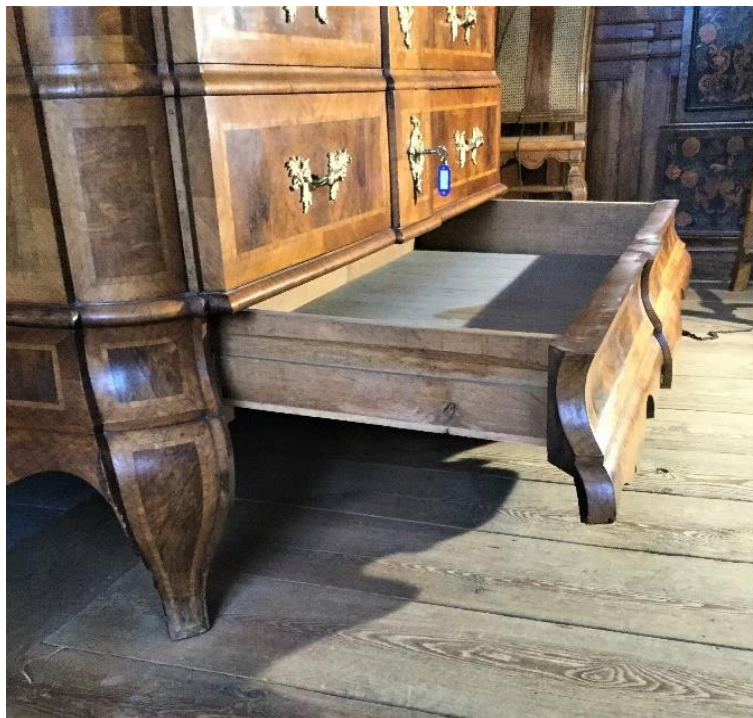
Figur 73: Här syns listen med dubbel funktion på de övre två kådorna som en del av skåpets profilering. Foto: David Fucik. Bild återgiven med tillstånd.
