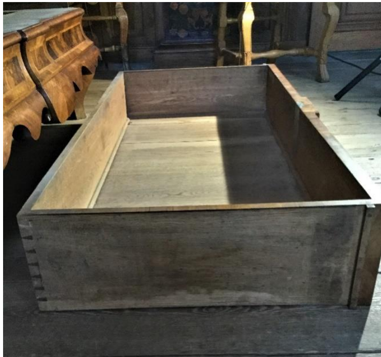
Figur 72: Låda från sidan, där listen med dubbel funktion syns längs till höger på lådsidestycket. Foto: David Fucik. Bild återgiven med tillstånd.
