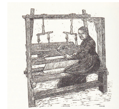
Figure 3.6 This illustration shows the traditional counterbalance loom (trissevæv). Illustration Poul Abrahamson. From the book Ole Højrup, Landbokvinden: Rok og kæmme, grovbrød og vadmel (Nationalmuseet, 1966), 234.
