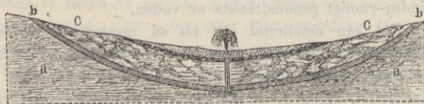
Fig. 6. Skematisk bild av en artesisisk brunn. a , ogenomträngligt underlag; b , vattenförande lager; c , ogenomträngligt överlag.
