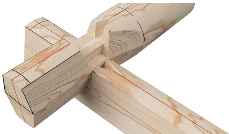
Figur 17. Mossränna. Gör en mossränna i haket. Mät uppsticket igen och skriv det synligt på ovansidan av stocken.
