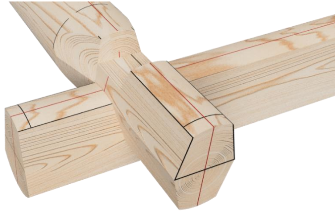
Figur 15. Påritning inhak. Markera placeringen av inhaket mätt från centrum i haket. Anvisning finns på ritning KBY612-02-01.
