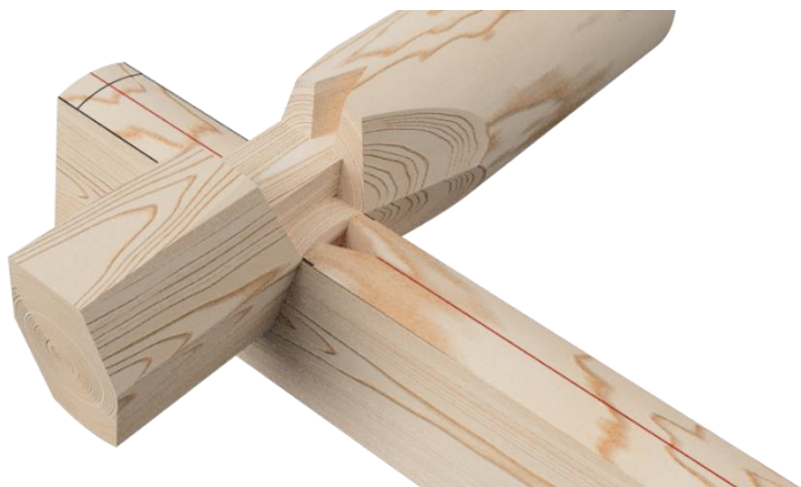
Figur 18. Färdigt överhak. Stocken är färdig efter att knutskallen bearbetats på ovansidan.
