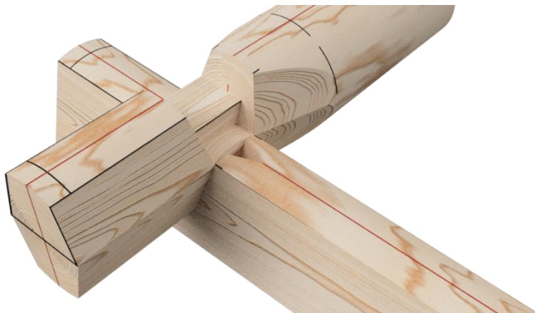
Figur 16. Tillverkning inhak. Hugg/såga ur för inhaket.
