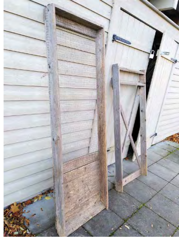
En upprätt modell som står direkt på marken fungerar så att komposten kastas genom sållet med spade. Den fina fraktionen faller igenom maskorna (1,5 cm svetsat rutnät) och samlas i en hög under sållet medan de grova bitarna rullar ner längs sållets lutande framsida och hamnar i en separat hög framför sållet. Sållet består av två delar som tas isär vid förvaring.
