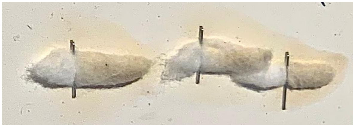
Figur 12 Tops som använts med 2-propanol för att rengöra ytan för punkt 1, 2 och 3 från gelrester.
