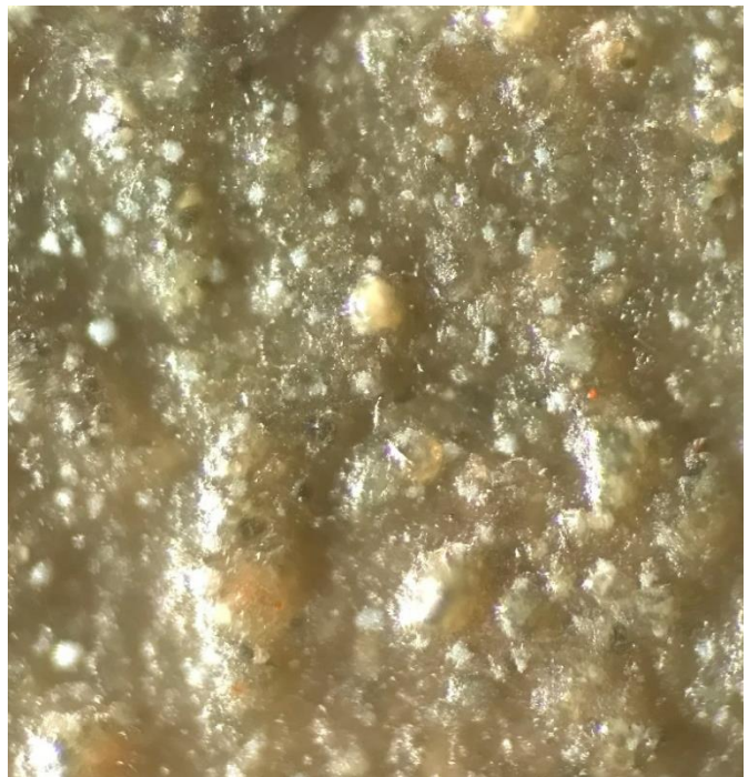
Figur 7 - Mikroskopbild av prov AL1g efter konsolidering med Funori. Tydliga fläckar kan ses på ytan men även i det underliggande skiktet.
