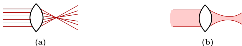
Figur 2.4: Två olika beskrivningar av hur en laser fokuseras genom en lins. (a) I geometrisk optik beskrivs strålar som konvergerar mot en fokuspunkt. (b) I vågoptik påverkas storleken på fokusområdet av diffraktion och aberration.
