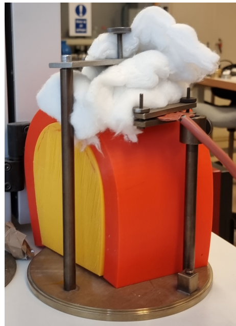
Figur 3: Den första mätningen med den 3D-printade hoven. Mätning på den yttre röda delen som representerar hovväggen.
