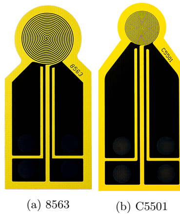
Figur 4: Hot Disk-sensorer som användes för att undersöka olika delar av den 3D-printade hoven. Sensor 8563 med en spiral med diameter 19,8 mm och sensor C5501 med en spiral med diameter 12,8 mm, bilderna är hämtade från [14].
