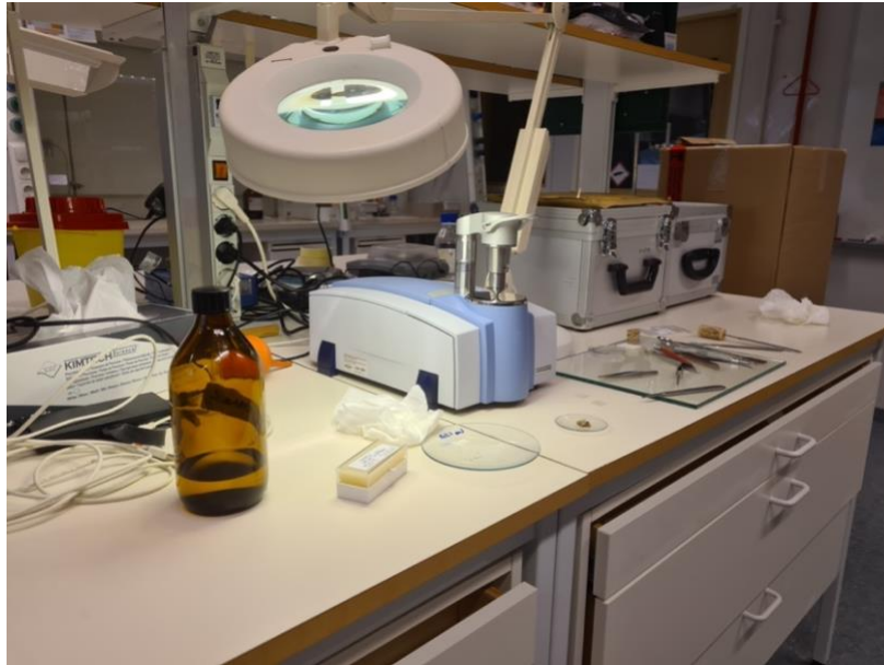
Figur 29. FTIR-instrument och verktyg som användes till analysen.
