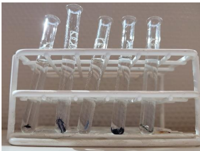
Figur.16 Fiberprover i 1ml vatten för test med Dosatest
