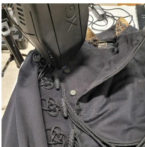
Figur.15 XRF mätning på bröst, vänster sida på GMM:855
