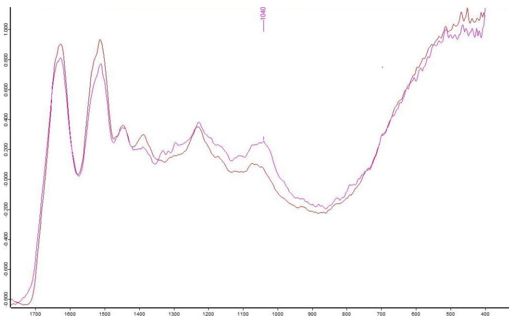
Figur.18 FTIR-spektrum för standardylle (röd linje) med FTIR-spektrum för prov GMM:1740 (rosa linje)
