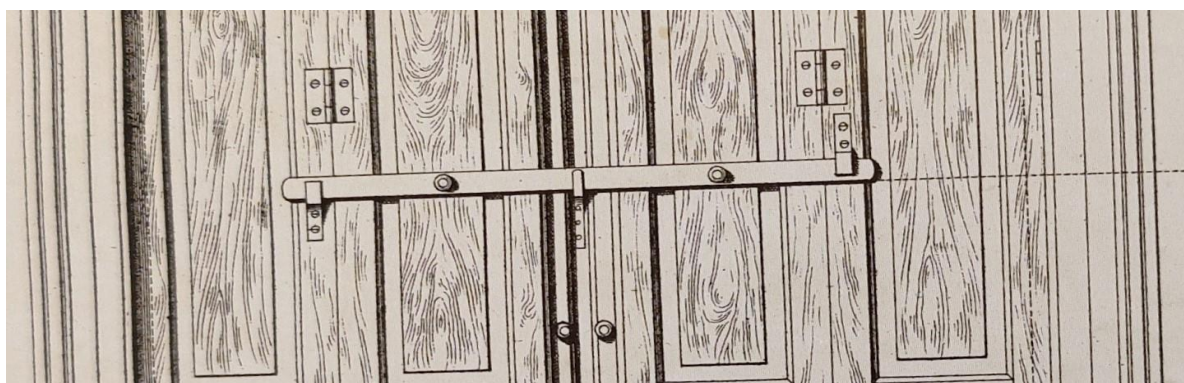
Figur 14 En bom är den säkraste låsningen för invändiga fönsterluckor. Källa. Graef 2003 s. 24
