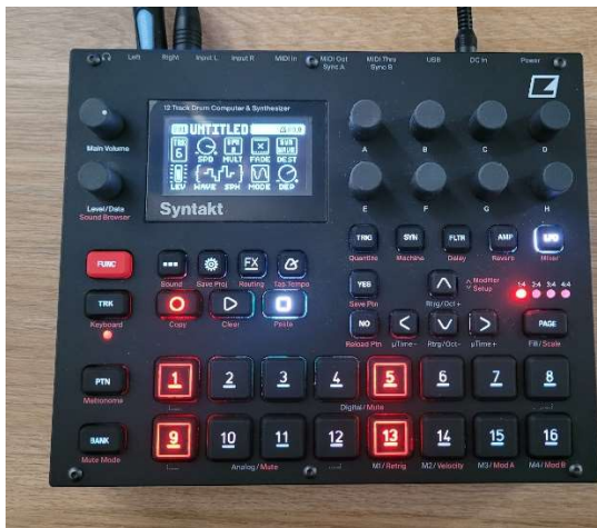
Bild 2B. Cirkeln är intryckt och Syntakten är i ”Grid mode”. Knapparna 1-16 är nu en sequencer.
