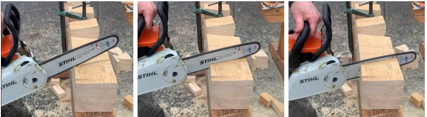
Figur 27. Laxstjärt tapphål variant 2, snitt fyra och fem. (Alkdal 2023)
