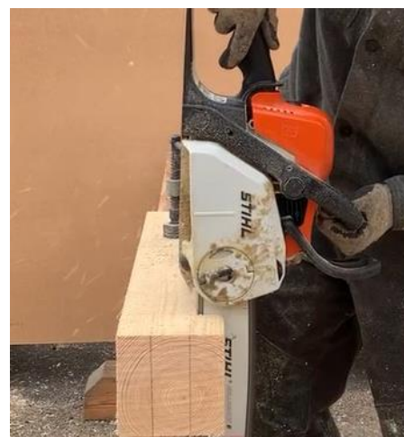
Figur 9. Tapp variant 1, snitt tre. Lämplig arbetsställning och tänk kring säkerhet vid detta sågsätt finns i resultatdelen sida 29. (Alkdal 2023)
