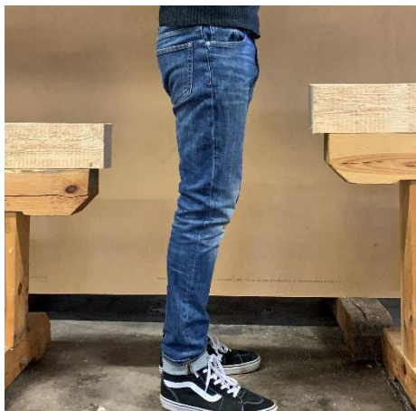
Figur 37. Till vänster syns den lägre 60cm bocken och till höger 70cm bocken. Mitt allround-ideal ligger mitt emellan på 65 cm. Givetvis är det individuellt vad som passar bäst. (Alkdal 2023)
