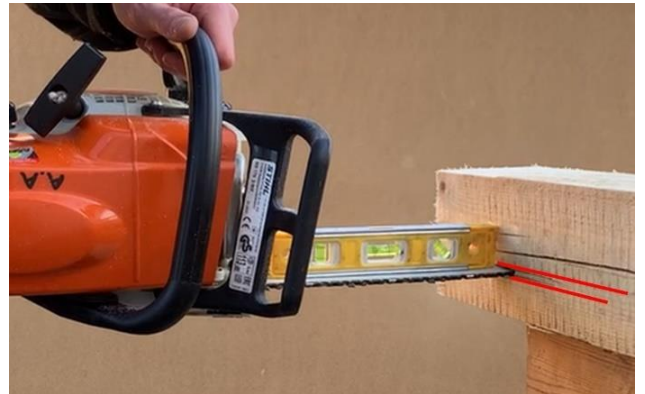
Figur 38. Instick med vattenpass och hjälplinje parallellt med hålets undre linje. (Alkdal 2023)
