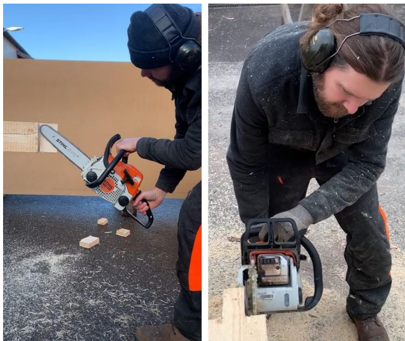
Figur 43. Putsning undersida svärdsspets samt förslag på lämplig arbetsställning. (Alkdal 2023)
