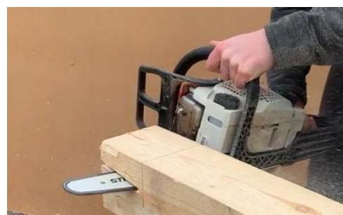
Figur 31. Hörnskarv med sned skärning variant 1, snitt fyra. (Alkdal 2023)
