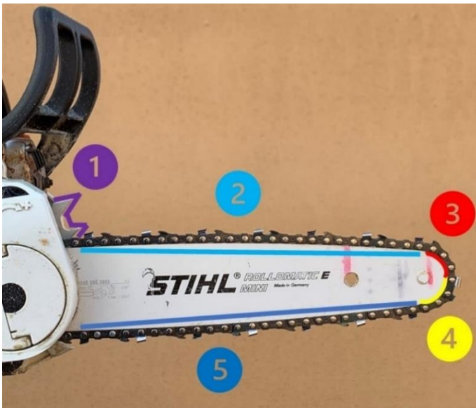
Figur 5. Motorsågens skärutrustning. Samtliga delar av sågens svärd går också att använda vid putsning. (Alkdal 2023)
