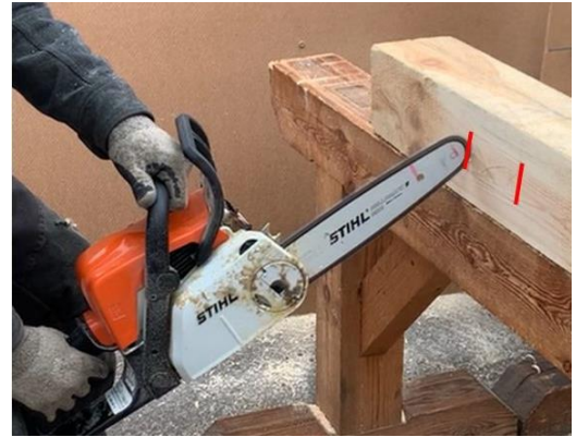
Figur 13. Tapphål variant 1, snitt ett och två. (Alkdal 2023)
