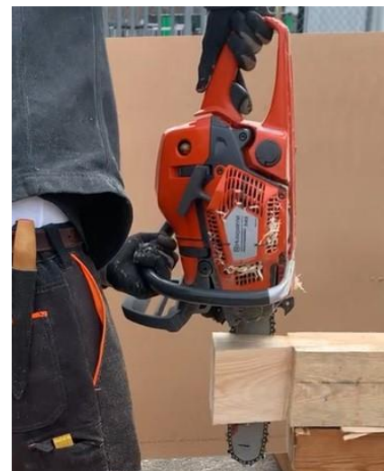
Figur 19. Laxstjärt tapp variant 1, snitt fem. (Alkdal 2023)
