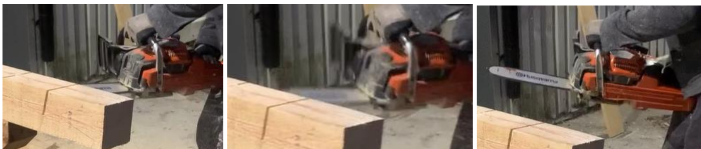
Figur 46. Kast fångat på film, på bild två träffade svärdets kastsektor virket och sågen kastas åt sidan och mot utövaren. (Alkdal 2023)
