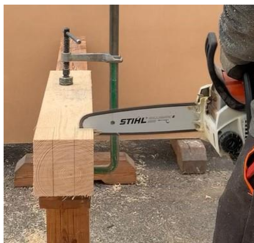
Figur 7. Tapp variant 1, snitt ett. (Alkdal 2023)
