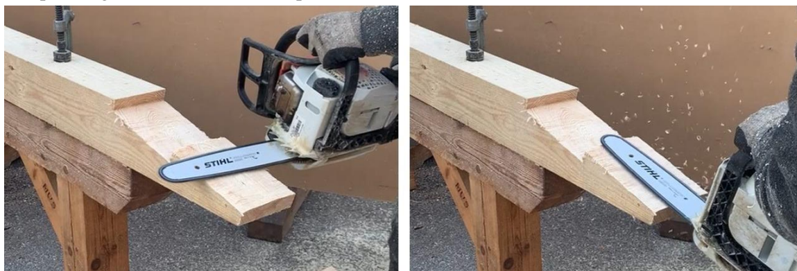
Figur 42. Putsnings med svärdet 90 grader mot virket och jäms med fibrerna. (Alkdal 2023)
