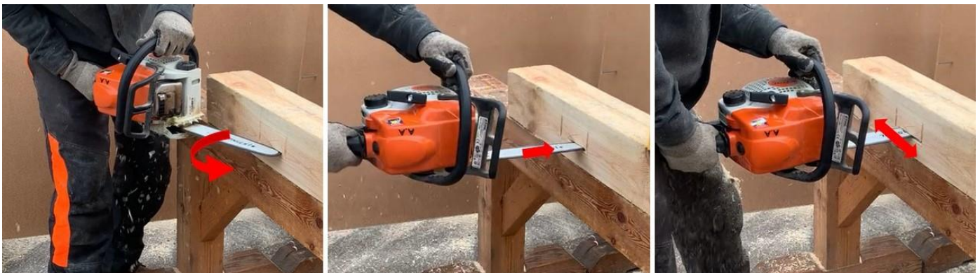
Figur 14. Tapphål variant 1, snitt tre och fyra. Instick och horisontell sågning. På sida 26 i resultatdelen återfinns råd och knep jag upptäckt under min undersökning gällande instick. (Alkdal 2023)
