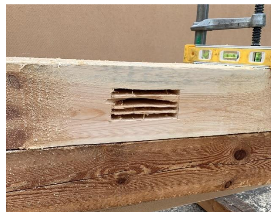
Figur 15. Tapphål, ytterligare instick för att rensa i tapphålet. Lagg märke till spåret till vänster där kedjan huggit tag i kanten och gått över lodlinjen. (Alkdal 2023)
