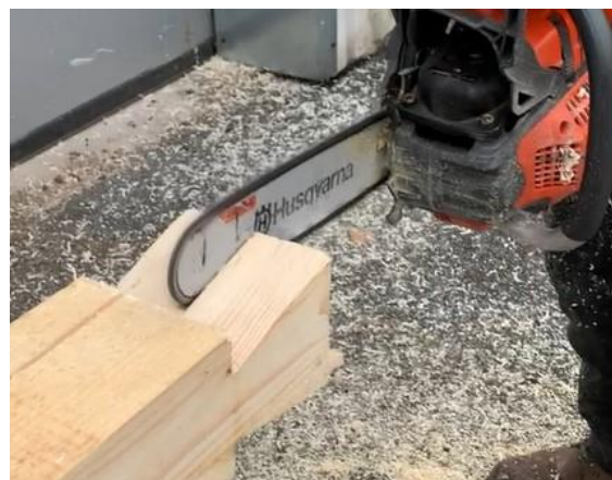
Figur 21. Laxstjärt tapp variant 1, snitt åtta. (Alkdal 2023)
