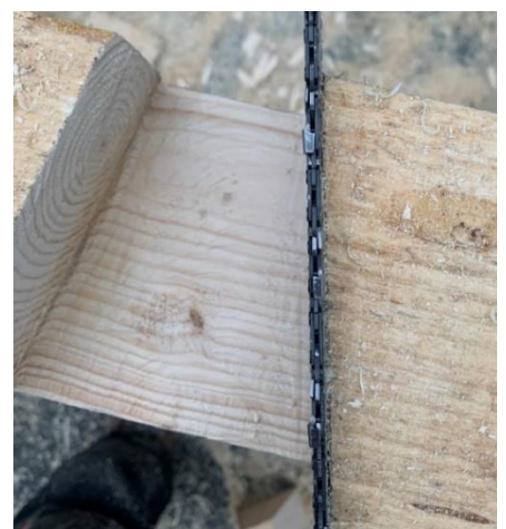
Figur 28. Laxstjärt tapphål variant 2. Ansättning längre in på svärdet som vid snitt fyra och fem ger enkelt ett spikrakt och fint resultat. (Alkdal 2023)
