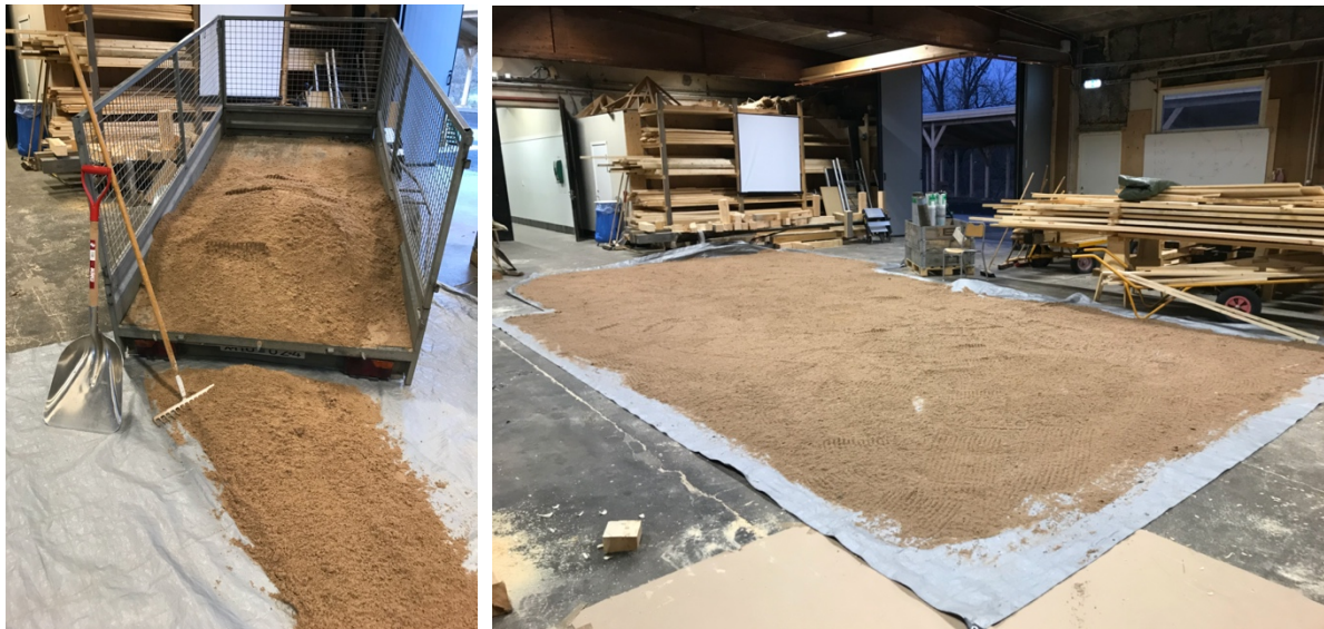
Figur 9. Fotografier av sandens torkningsprocess. På bilden till vänster har sanden just hämtats fuktig och lastas av. Sanden är mörkare vilket tyder på att den är fuktigare. Till höger ser vi det eftersträvade resultatet av mursanden. Sanden har här torkat ut lite och fått en ljusare färg.
