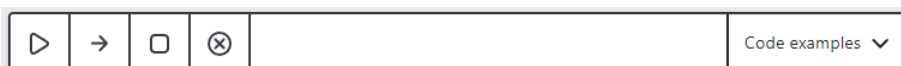
Figur 5.2: Användargränssnitt för menyfältet. Alla knappar till vänster styr exekveringen och knappen till höger genererar en rullgardinsmeny med kodexempel.
