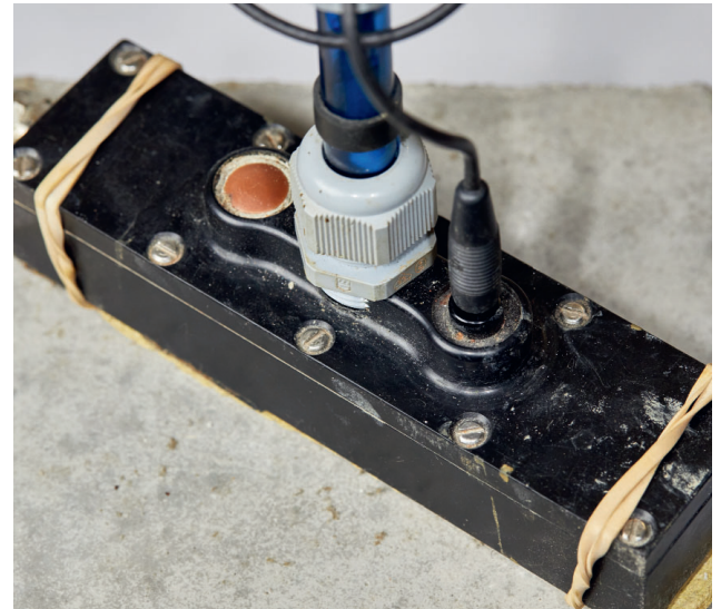
Figur 7.7. Till vänster en principskiss för halvcellpotentialmetoden. Till höger en en elektrod i verkligheten. Illustration och foto: Urs Müller.
