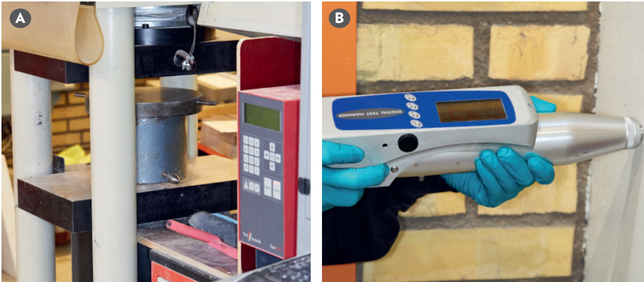
Figur 7.13A-B. Till vänster en universalprovningmaskin under en tryckhållfasthetsprovning. Belastningen ökas succesivt tills provkroppen går sönder. Till höger en studshammare som mäter betongens hållfasthet. Foto: Urs Müller.
