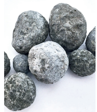
Figur 3.7. Kulor av portlandcementklinker. Portlandcement tillverkas av kalksten och lera. Råvarorna måste innehålla kalciumoxid, kiseloxid, aluminiumoxid och järnoxid. Blandningen mals i en råkvarn och hettas upp. Den produkt som kommer ur cementugnen kallas klinker och utgörs av sådana här sfäriska kulor som kyls snabbt. Foto: Urs Müller.
