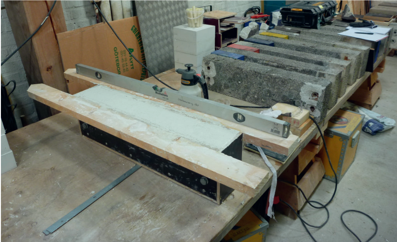
Figur 9.6. Formen till de mellanstora rätblocken fylld med betong inför en provgjutning. Formarna byggdes så att de gick att ta isär innan betongen hade bränt.
