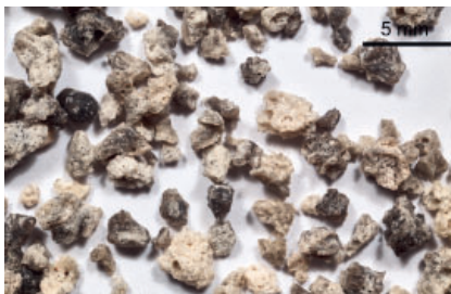
Figur 3.9. Granulerad masugnsslagg har använts som ersättning för portlandcement sedan 1800-talets slut. Masugnsslagg är en restprodukt vid framställning av tackjärn i masugnar. Foto: Urs Müller.
