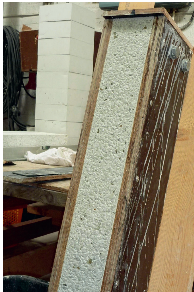
Figur 9.8. Färdig provyta som den blev efter att ballastens synliga yta frilagts. Foto: Stefan Holmgren.
