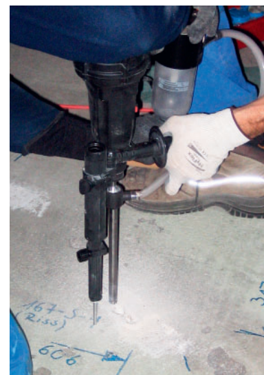
Figur 7.11. Bormaskin med vakuumsug och en 20 mm specialborkrona. Foto: Urs Müller.
