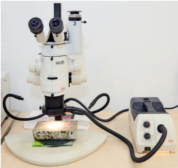
Figur 7.14. Ett stereomikroskop med belysning (vänster). Bilder av sprucken betong är fotograferad genom ett stereomikroskop under infallande ljus respektive UV-ljus. Under UV-ljus framgår sprickvidden och sprickutbredningen i starkt ljusgrön kulör. Foto: Urs Müller.
