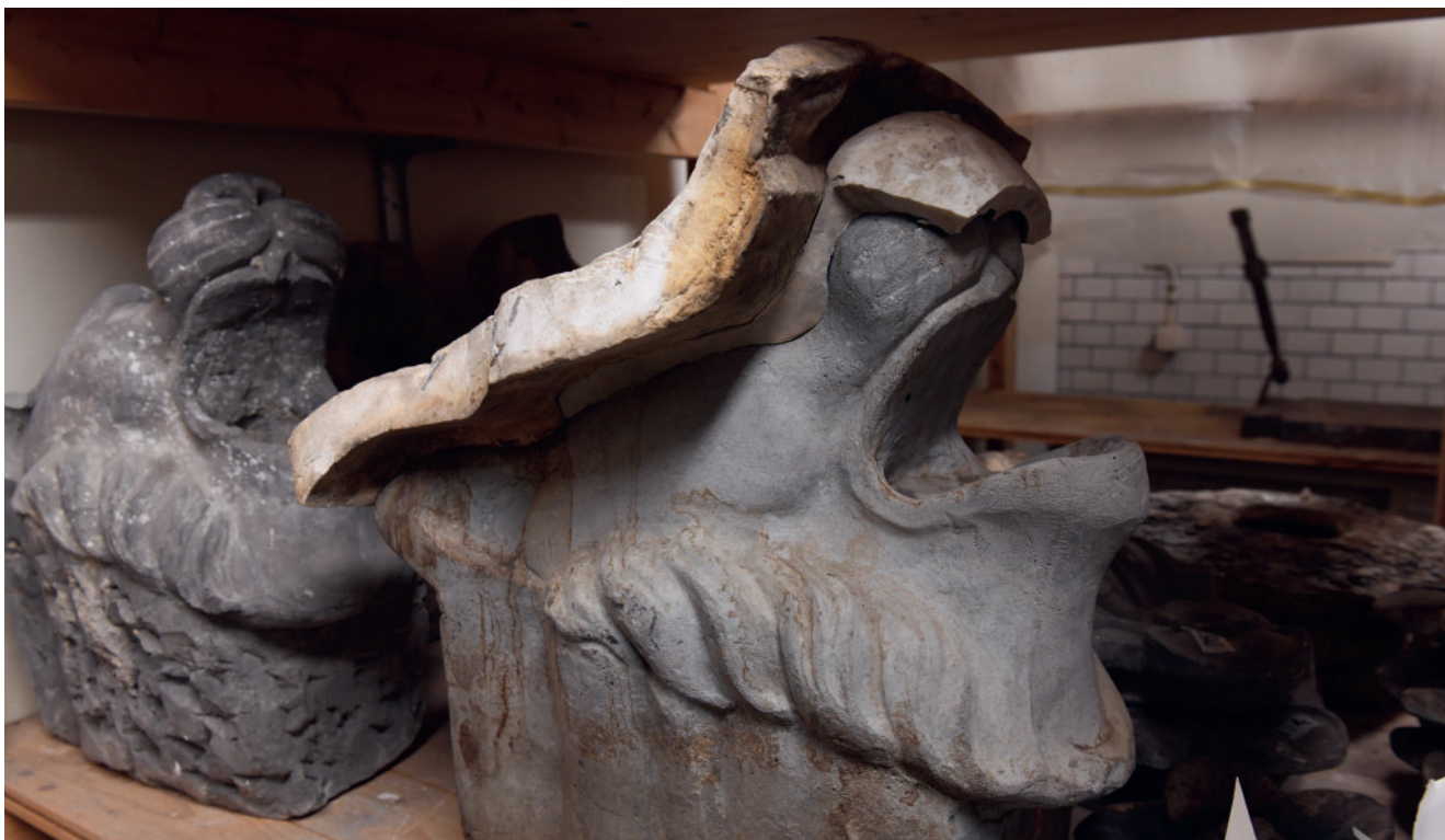
Figur 2.8. Två vattenutkastare till universitets- huset i Lund. Den färdiggjutna betongdetaljen i förgrunden har kvar delar av sin gipsform och bilden visar något av den komplicerade formbyggnaden, som krävdes då tredimensionella detaljer skulle gjutas. Foto: Sven Olof Ahlberg, 2020.
