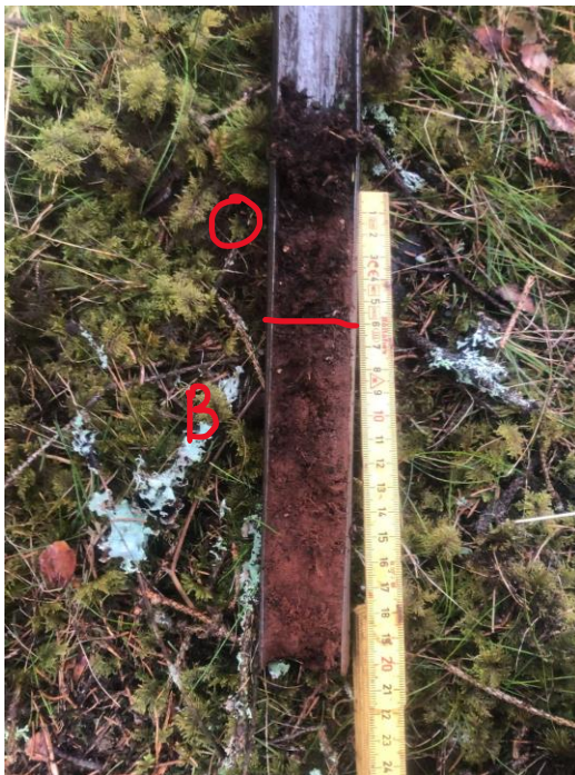
Figur 4. Jordprovtagare med jord från provplats 3. Horisont O och B är synliga.
