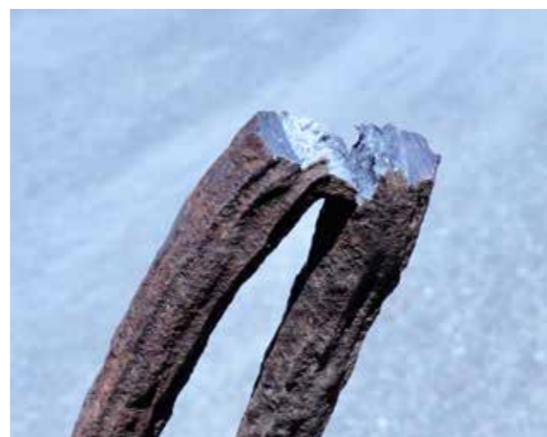
Bryttest på välljärn. Här ses tydligt hur järnet när det böjs, på liknande sätt som ett träd, bryts i längdriktningen och delvis följer »ådringarna« av slagg.
