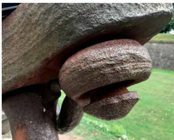
Typisk ådring på välljärn som varit utomhus under flera århundraden, här på ett ankare vid Kalmar slott. Lagren av silikathaltig slagg ses tydligt som långa stråk i järnets längdriktning. Notera att inte nämnvärt mycket material förlorats.
