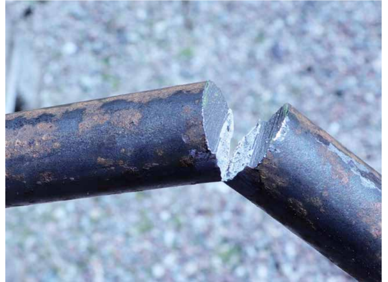
Bryttest på modernt stål. Eftersom stål är ett homogent material bryts det rakt av.
