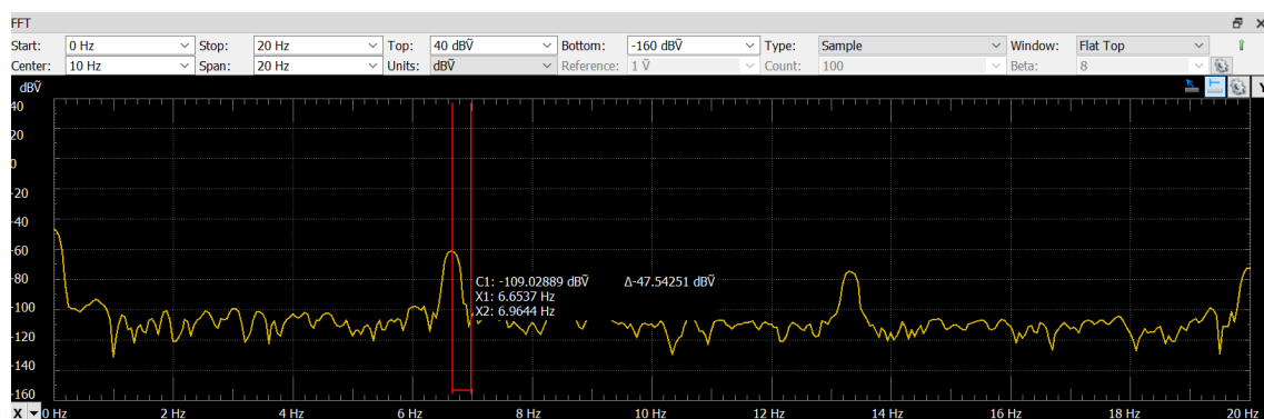
Figur 7.1: Oscilloskop för 6.66Hz stimuli
