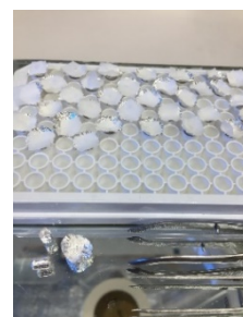
Bild 15: filterpapper torkar på utbredda silverkapslar. Intakta silverkapslar syns i vänstra nedre hörnet
