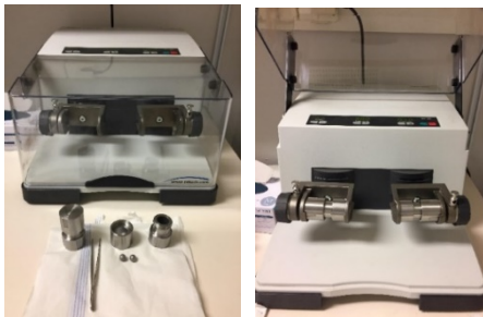
Bild 6 & 7 visar utrustning och skakmaskin som malde jordproverna.
