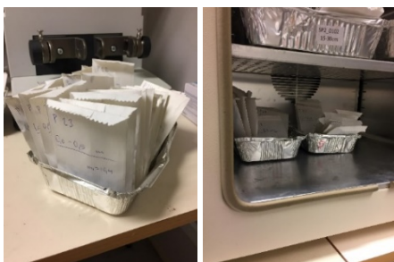
Bild 4 & 5 visar papperspåsar med jord som ska torkas i ugn på 50 grader.
