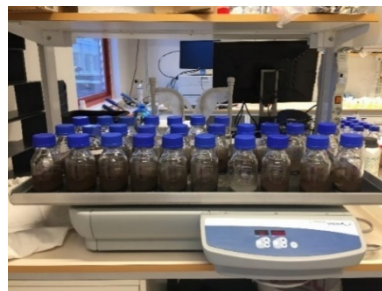
Bild 11: direkt efter extraktion ställs jordproverna på skakbord i 60 minuter
