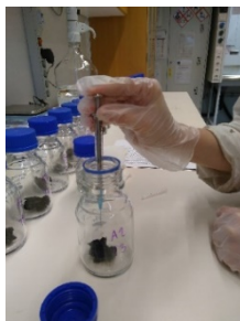
Bild 9: 0,5 ml ^{15}\text{N} -ammonium tillsätts med spruta
