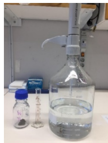
Bild 10: extraktion, 20 ml KCl tillsätts med mätglas
