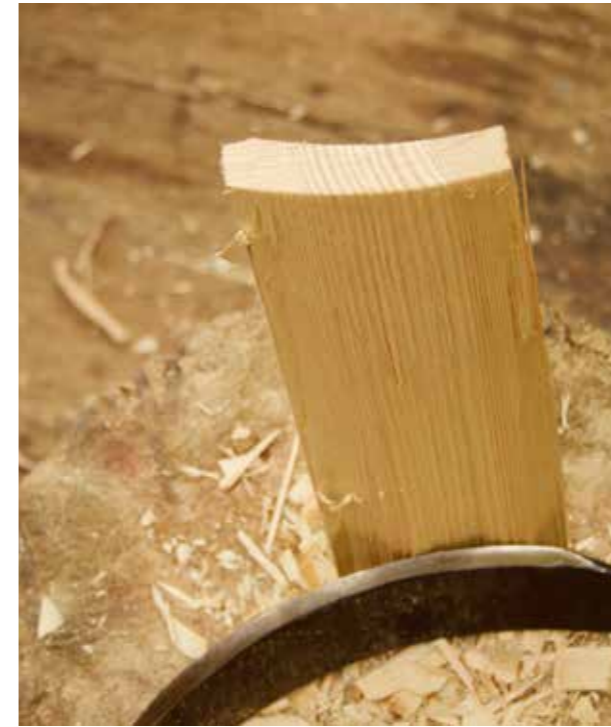
Klyvning med svängt klyvjärn. Här ser man på bilden till höger hur klyvningen rätat ut sig.
