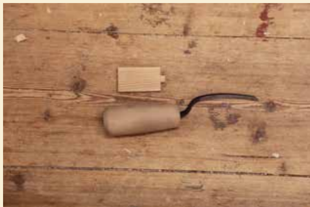
Skjutjärn och mått för att mäta djupet på laggen (spåret för botten)
