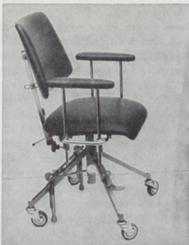
Realstol utrustad med: Förflyttningsbroms, extra stor ryggplatta, låsbar sitssnurrning, hög- och sänkbara armstöd, 4 st 75 mm länkrullar.
