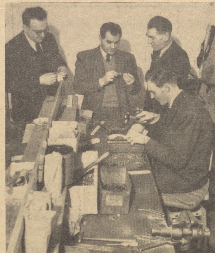
Ovan: Här nitas detaljer till espagnoletter. Fritidshemmet har haft stora beställningar på sådant arbete.
