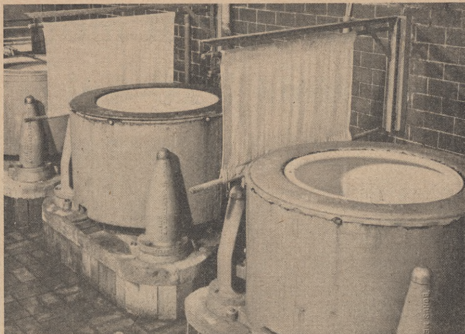
I sådana här centrifuger får man fram råpenicillin som ett vitt pulver.
