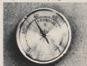
En hygrometer används för att mäta luftfuktigheten.
