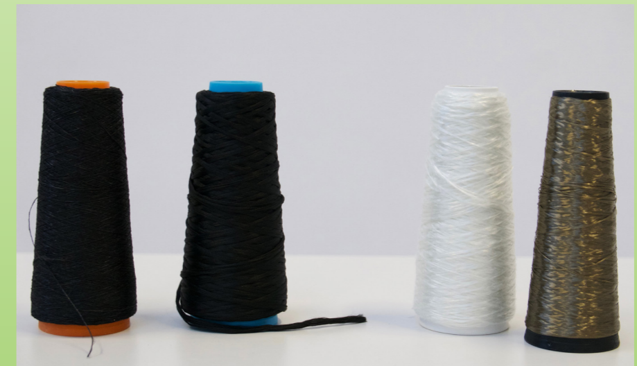
Överst: Skiss dubbelväv, Trevira CS Pemotex, basaltgarn och polypropylengarn. Mitten: Samma skiss dubbelväv efter krympning genom värmeexponering. Längst ner: Garner från vänster till höger: Trevira CS Pemotex, Trevira CS Outdoor, glasfibergarn och basaltgarn. Foto: Margareta Zetterblom.
