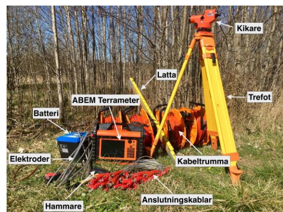
Figur 8 - Bilden visar utrustningen som användes i fält. De instrument som användes för avvägning var trefot, kikare och latta. Till resistivitetsmätningarna användes ABEM Terrameter, kabeltrumma, anslutningskablar, elektroder, hammare och batteri.
