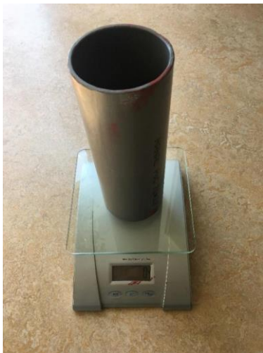
Figure 8. Cylindern och digitalvågen som användes ute på fält för att mäta snödensiteten.
