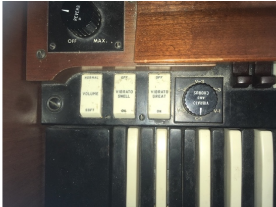
Bild 5. Reglage för chorus/vibrato
