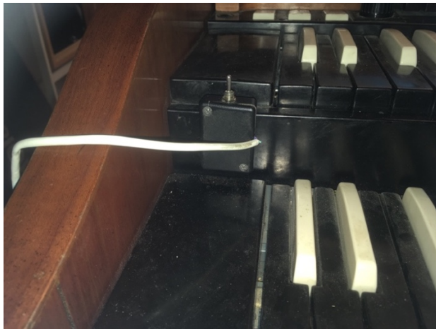
Bild 3. Switch för hastighetsstyrning av leslie.
