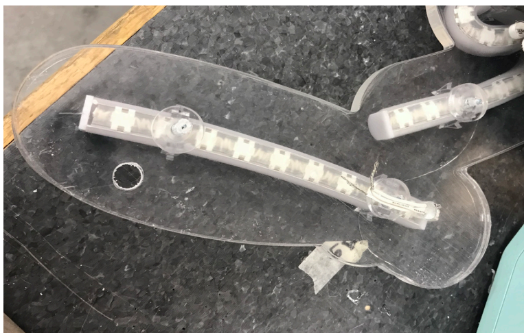
Figur 26. Baksidan av en LED-neonskylt på Nordiska Neon & Diod i Västerås.
