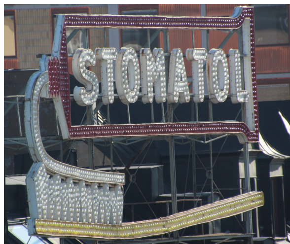
Figur 3. Stomatolskylten sedd från restaurang Gondolens uteservering ovanpå Katarinahissen en solig dag i juni 2019. En vanlig missuppfattning är att Stomatolskylten, ursprungligen från 1909, är en neonskylt trots att den i själva verket består av 1361 glödlampor.
