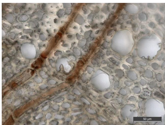
Figur 14 Prov D1 bild 4 efter urlakning i DTPA visar att de svarta partiklarna urlakats och att snitten är generellt ljusare.
