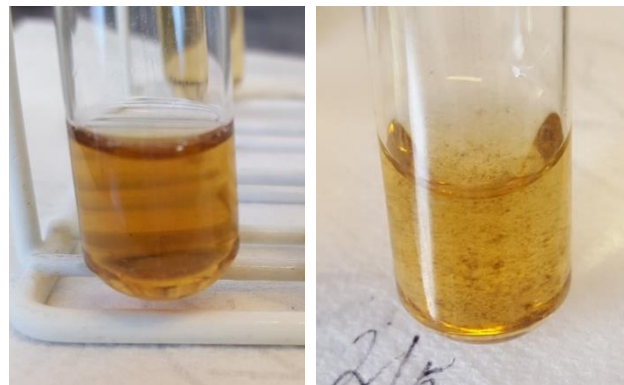
Figur 20 Utfällningsreaktion för urlakningsvätskan från D7. Före (vänster), efter (höger).
