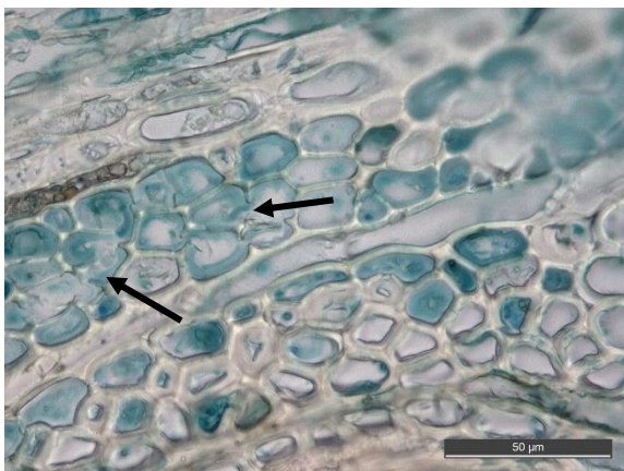
Figur 55 Mikrofoto på tvärsnitt ca. 3 mm från ytan. Här syns även mitt lamellen skadad (pilar). Förstoring X63.
