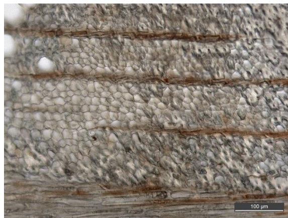
Figur 28 D3 bild 12 efter urlakning. De mesta svarta partiklar har urlakats. En del deformation av cellstrukturen kan observeras.
