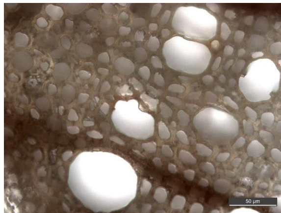
Figur 26 D2 bild 15 efter urlakning visar skador/deformering av cellstrukturen där järnet suttit.
