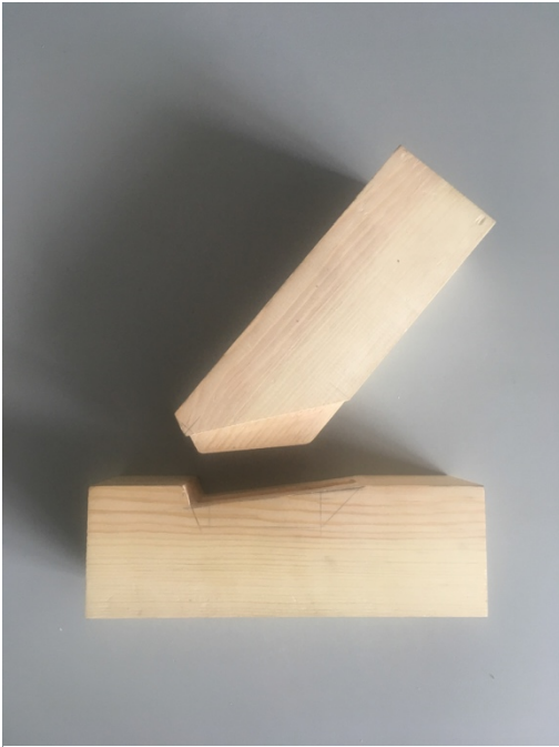
Figur 22. Fysisk modell över snedtapp med ansats
