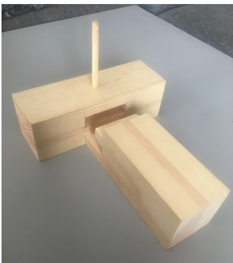
Figur 20. Fysisk modell över bladad tapp med dymling
