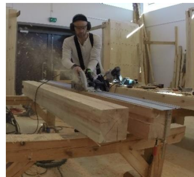
Fig. 40, Notfräs ut ett spår.
