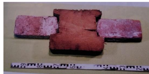
Fig. 14, Koppsida på tegelsten infälld i stolpe på tysk kyrka (Ekkhart 2003, s. 65).
