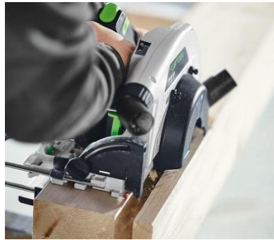
Fig. 44, Spåra med notningsenhet, här med parallellanslag (Festool 2017).
