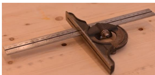
Fig. 35, HK85 med VN-HK85 130x16–25. Fig. 36, Kombinationsvinkelhake med gradinställning. Fig. 37, FS/2700/2.
