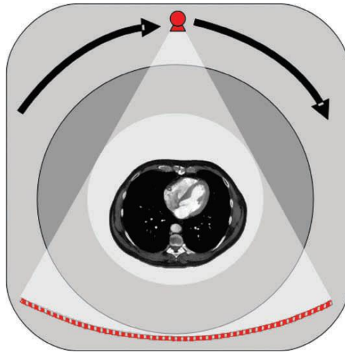
Figur 1. Röntgenröret och detektorn roterar runt objektet. Bild: Schilham, et al. 2010.
