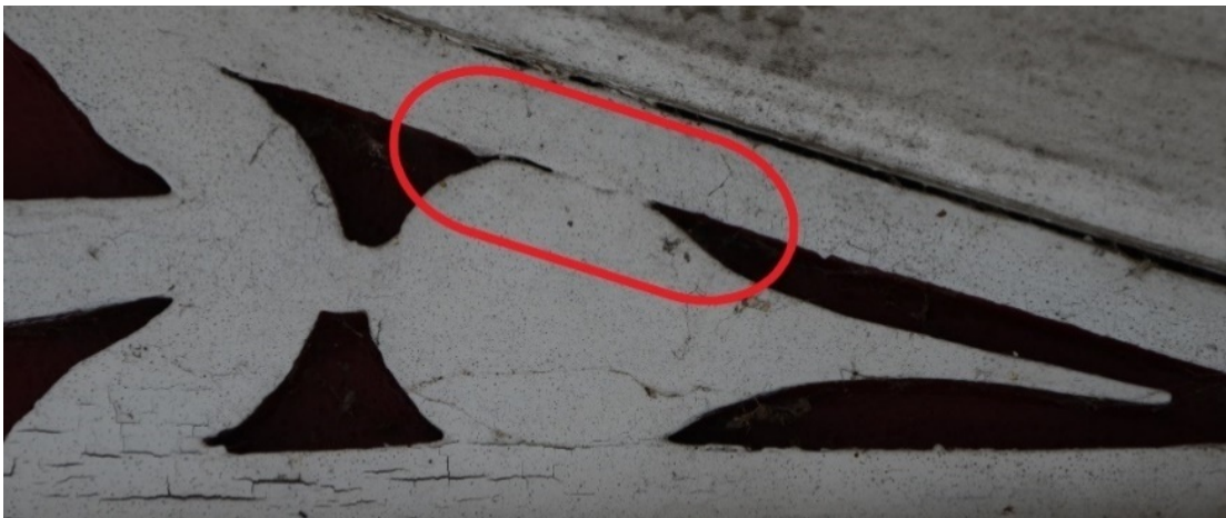
Bild 23. Delar av mönstret är genomsågat vid tillverkningen.
