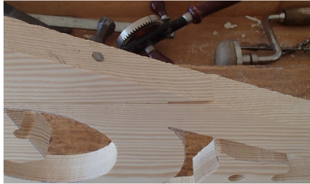
Bild 50. Spikning i den lutande delen av ramen.
