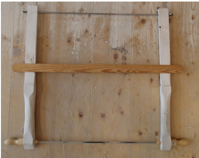
Bild 34. Den ombyggda sågen med längre armar.
