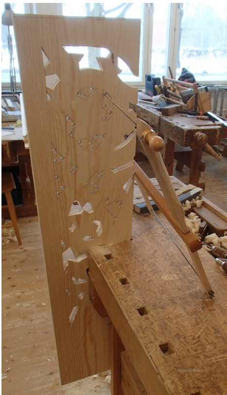
Bild 36. Fastsättning av materialet vid sågning.
