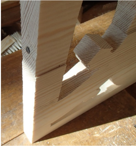
Bild 49. Spikning i ramen, stående delen.
