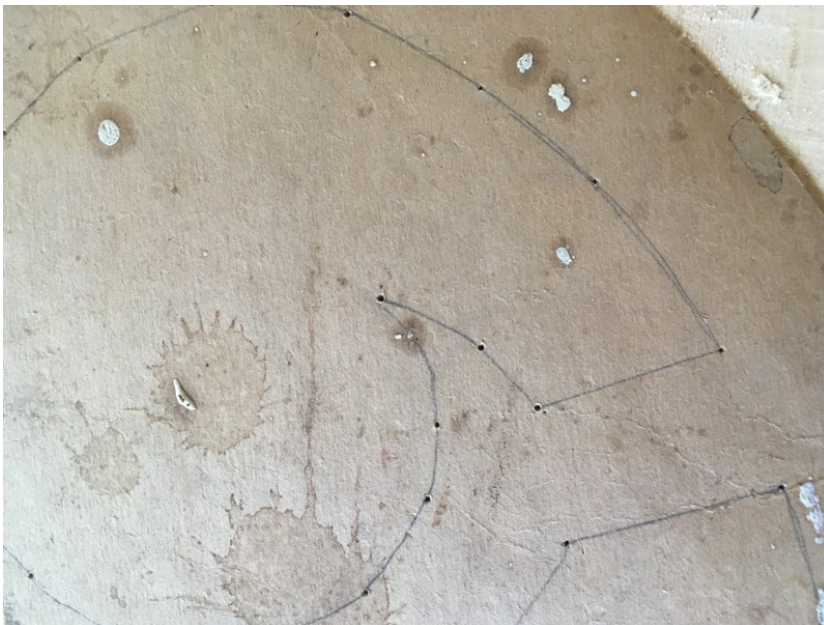
Bild 27. Mönster med märken efter syl för överföring av mönster. (foto: Tomas Karlsson 2018)
