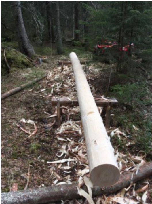
Figur 53. Trädet är fällt, apterat och barkat.
