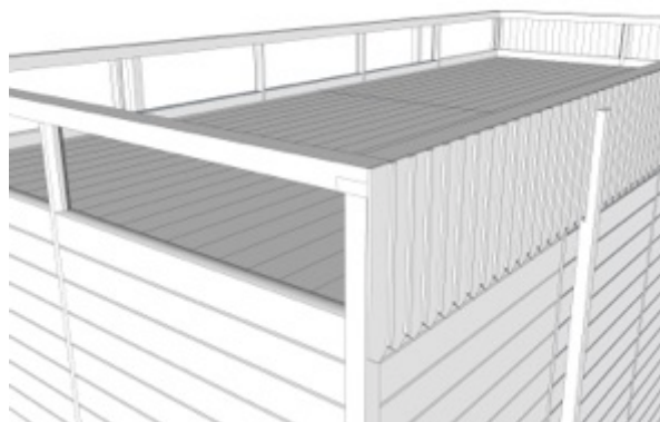
Figur 41. Vinden - Golvet läggs och sedan kan takkonstruktionen och panelen göras färdig. Mellan det översta skiftet och lång och tvärbandets underkant är nu ca en meter.
