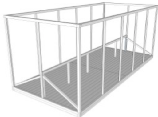
Figur 36. Inre stolpkonstruktion – Den inre stolpkonstruktionen reses. Stolparna är nertill tappade i golvsåarna och upp till i bjälklagets långa golvsås. De yttre stolparna fixeras desutom i gavelstolparna med hjälp av gängstänger.
