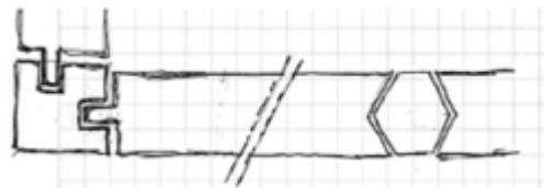
Skiss av skiftesverket i Aspetorps magasin. T.v. hörnstolpe med spår, t.h. sexkantig stolpe på väggyta, utvändigt dold av de vita täckbräderna. Skiss TCq. Se även foto s. 11.
