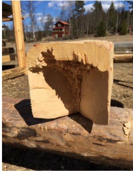
Figur 62. Skiftet vänds för att inte fibrerna sak brytas och virket spjälka när man hugger.
