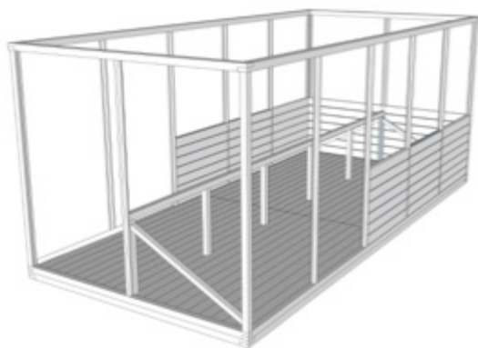
Figur 37. Skift – Skiften kan nu börja monteras till den höjd där golvsåarna ska ligga.
