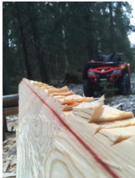
Figur 55. Stocken ligger på arbetsbockar och fasning sker på den vänstra sidan av stocken.
