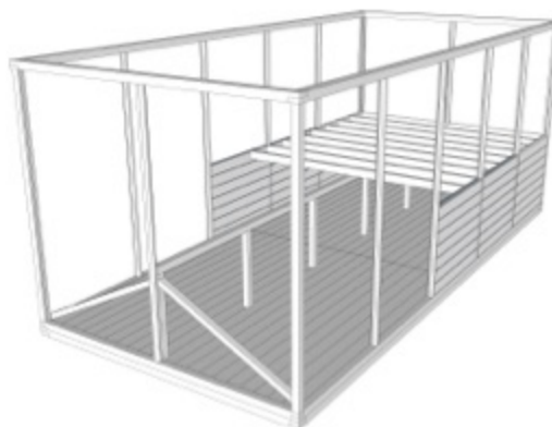
Figur 38. Bjälklag – Golvsåarna läggs in. Golvsåarna är inlaxade i skiften.
