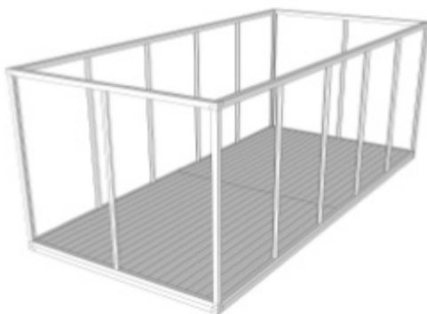
Figur 35. Kort- och långband – Alla stolpar är på plats och låsta med kort- och tvärband. Den strävning som använts behövs fortfarande i detta läge.
