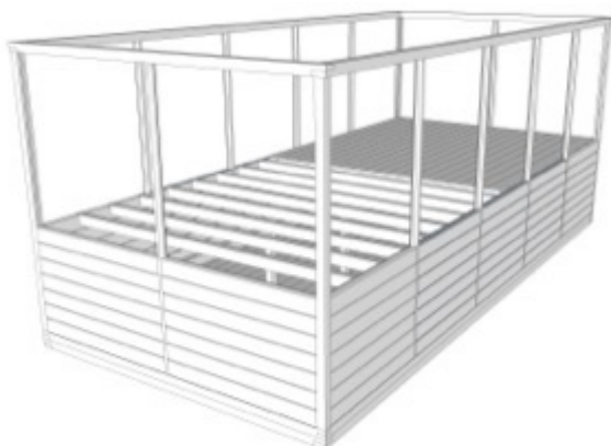
Figur 39. Plankgolv – Golvet kan läggas allt eftersom golvsåarna ligger på plats.
