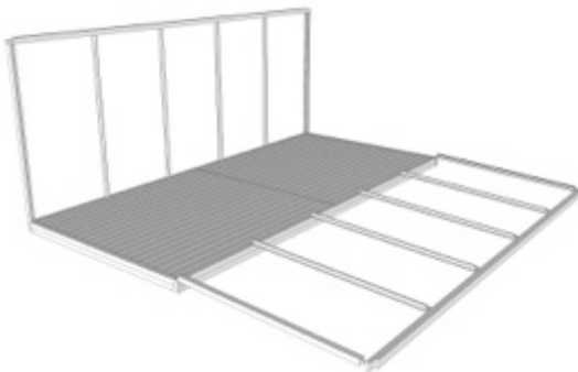
Figur 33. Stolpar – Resning av långsida. En vanlig arbetsmetod för att resa stommen är att stolparna på långsidan sätts ihop med långbandet och sedan reses. När detta arbetet görs krävs provisoriskt strävning.
