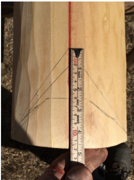
Figur 59. Skiftets v-form görs på olika på de två ändarna. Här görs v-formen 12 cm djup
