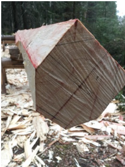
Figur 55. Stocken ligger på arbetsbockar och fasning sker på den vänstra sidan av stocken.
