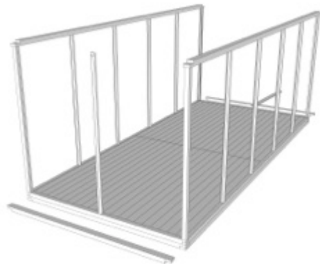
Figur 34. Stolpar – Resning av gavel. När båda långsidorna är rest kan den mittersta gavelstolpen resas och sedan låses med tvärbandet. De fyra hörnstolparna har alla spår, resterande är åttkantiga.
