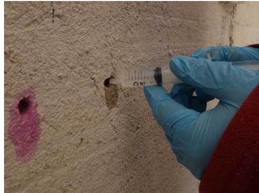
Figur 8 (Foto: Emil Stangenberg) Fenolftalein appliceras i borrhålen.
