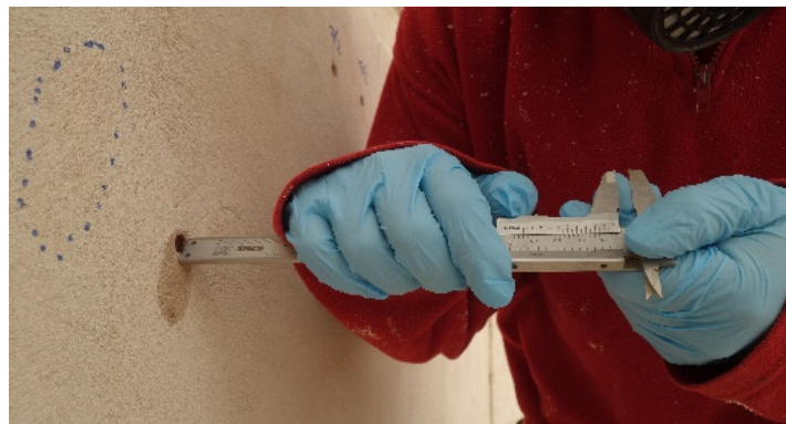
Figur 9 (Foto: Emil Stangenberg) Efter applicering av fenolftalein mäts avståndet från putsytan in till tydligt färgomslag med hjälp av ett skjutmått.
