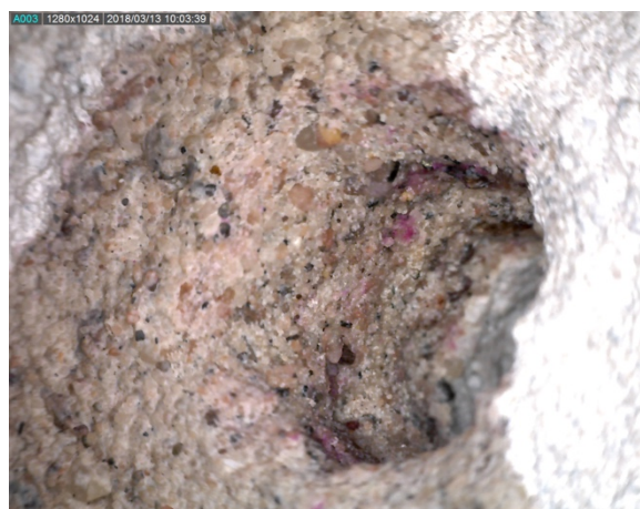
Figur 16 (Foto: Mikel Thorstensen). Bilden visar puts E vid det sista provtillfället. Fotot är taget några sekunder efter applicering av fenolftalein- och alkohollösning.
