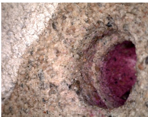
Figur 15 (Foto: Mikel Thorstensen). Bilden visar puts E vid det första provtillfället. Fotot är taget några sekunder efter applicering av fenolftalein- och alkohollösning.
