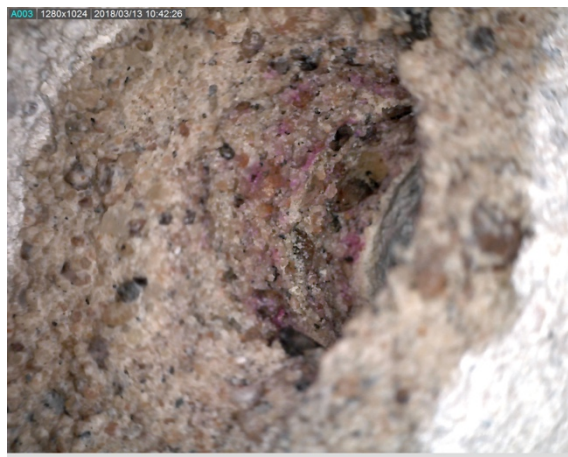
Figur 14 (Foto: Mikel Thorstensen). Bilden visar puts D vid det sista provtillfället. Fotot är taget några sekunder efter applicering av fenolftalein- och alkohollösning.
