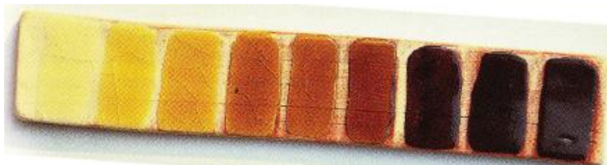
Fig. 26. Exempel på olika färgnyanser av en blyglasyr, beroende på ration av Fe_2O_3 . Den ljusaste motsvarar ca 1%, den mörkaste ca 6 – 8% järn.
