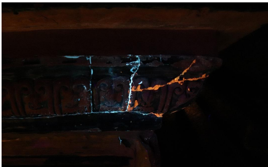
Fig. 34. Exempel på spår av lagningar, sedda under UV – ljus. Bilden visar lagningar på piedestalen, sida D, med både bruna (orange) och genomskinliga (vittblått) lagningar. Foto: Angelica Fingal
