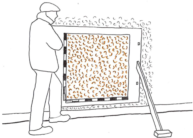
Figur 6. Ramen hålls upp mot fasaden.
