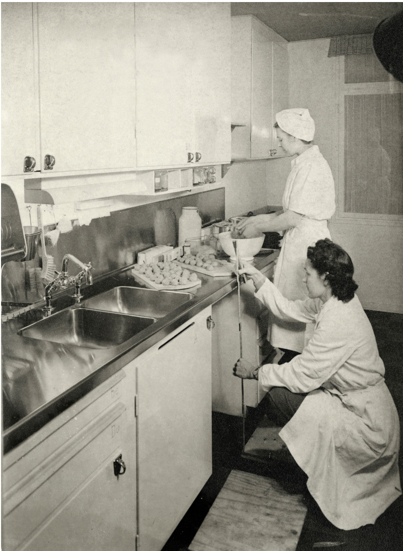
Fig. 7. Undersökningar i ett kök av HFI 1946. Här mäts arbetsbänkens höjd medan hushållsarbete utförs.
