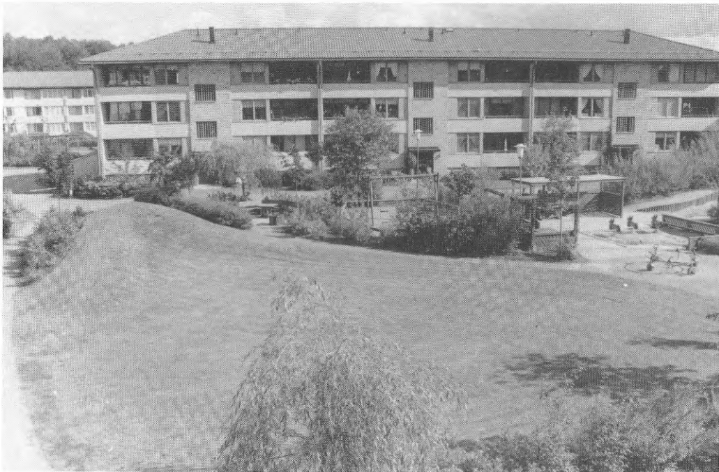
Figur 118. Enligt fastighetsskötaren var kullen knepig att klippa på grund av för branta lutningar. (1990)
