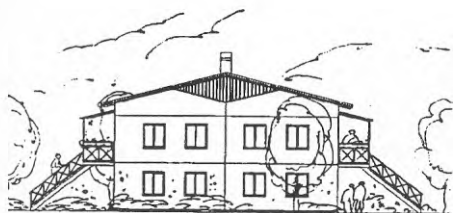
Figur 2:5. Gavelfasad, hustyp A och B. Från tävlingshandlingarna av Skanska AB och White Arkitekter 1991-08-28. Gavelfasaderna kom att utföras träpanelade istället för med synliga betongelement som tävlingsförslaget visar.
