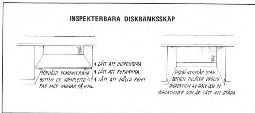
Figur 21 Specialutförande, inspekterbara diskbänks- skåp
