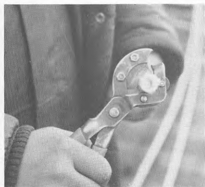
BILD 54 Rören kapas med en specialttång.
