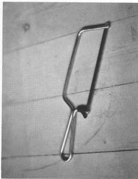
BILD 184 Montören utnyttjade en "minisåg" att kapa plaströren med.
